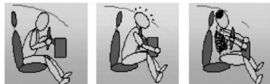
Movimento do corpo de um motorista sem cinto de segurança no momento de uma colisão.
