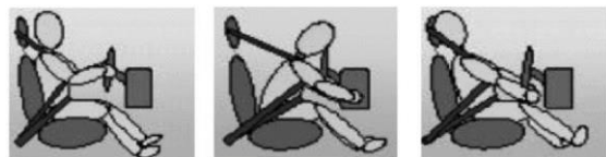
Movimento do corpo de um motorista com cinto de segurança no momento de uma colisão.
